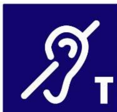
Oreille barrée + T = boucle d'induction magnétique installée
